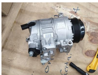
C-COMPRESOR AIRE ACONDICIONADO
