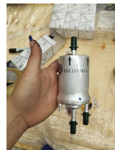
C-FILTRO DE COMBUSTIBLE
