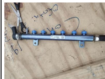
C-DISTRIBUIDOR COMBUSTIBLE CRA
